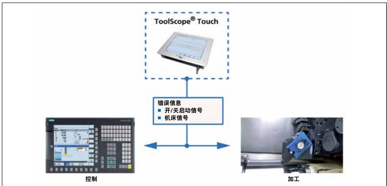
机械式工具监测流程
