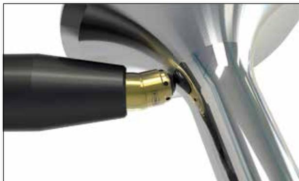
深滚压气门的柄体、弧面和平面。
